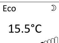
La différence recommandée entre les valeurs de température de confort et Eco est de 3,5°C.
