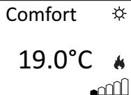
Confort Si la température de confort est réglée à une valeur inférieure à la température d'Eco, celle-ci est automatiquement réinitialisée à la valeur de confort - 0,5°C.
